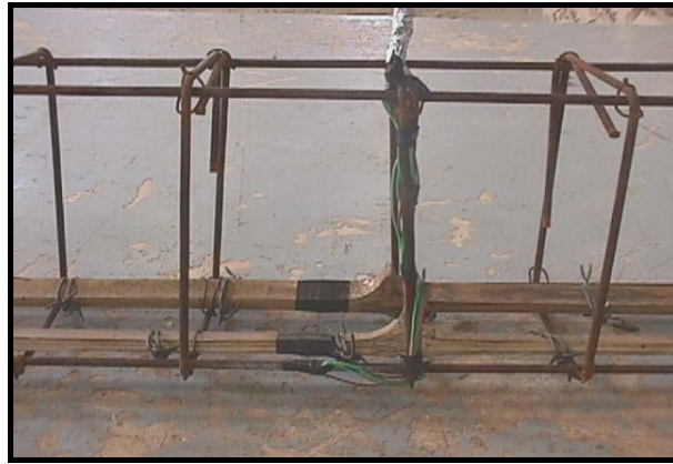
Figura 2 – Detalhe dos extensômetros colados nas taliscas de bambu
