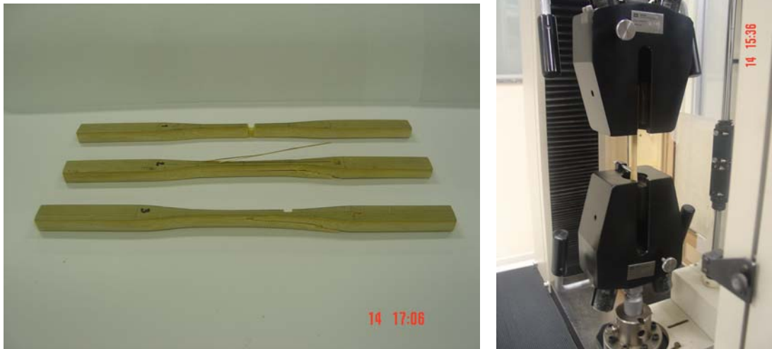
Figura nº 11: Corpos de prova rompidos no ensaio de tração. Fonte: Marquez, 2007
