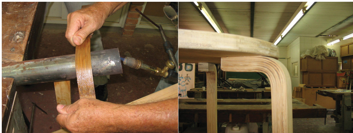
Figura 05 – Curvatura das ripas de bambu para fabricação do componente “pé”.
