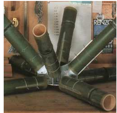
Fig.18 - unión con platina - R.Piano
