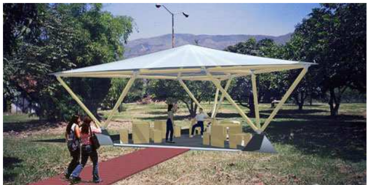
Fig.37-hexágono con 4 tetraeders horizontales + membrana rendering
