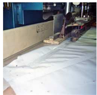
Fig.49 - sellado a calor de la tela
