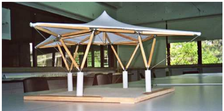
Fig.39-octágono con 4 tetraeders horizontales + membrana maqueta
