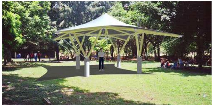
Fig.38- octágono con 4 tetraeders horizontales + membrana rendering
