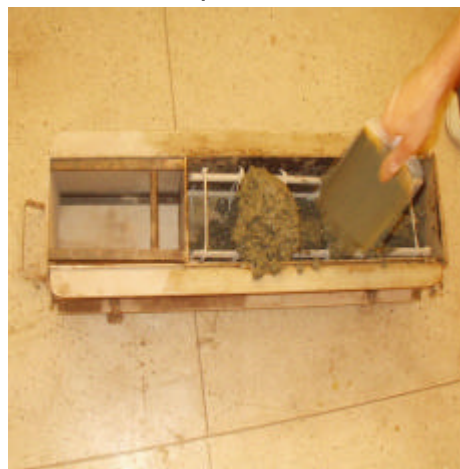
Foto 22 – Colocação do concreto na forma
