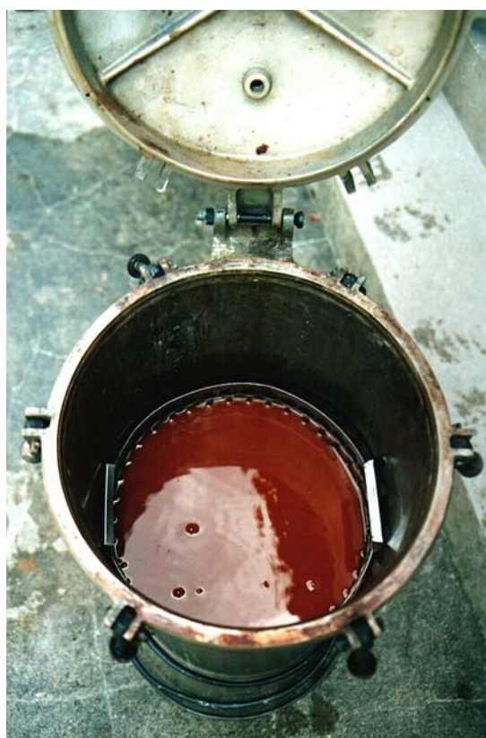
Figura 10 – Tratamento em autoclave por vácuo-pressão (célula-cheia).
