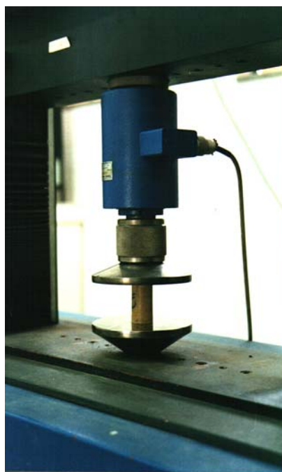
Figura 8 – Ensaio de resistência à compressão paralela às fibras
