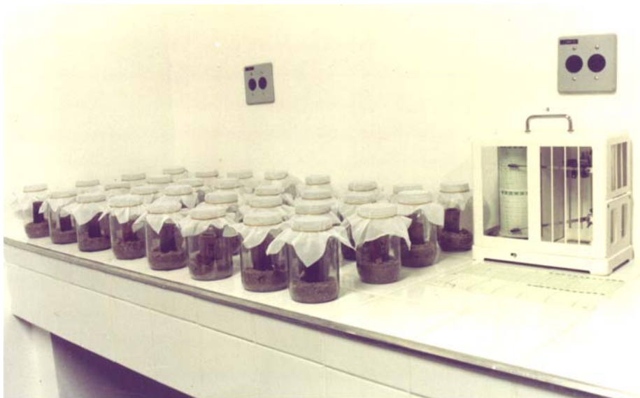
Figura 11 – Ensaio laboratorial com térmitas ( Nasutitermes macrocephalus )
