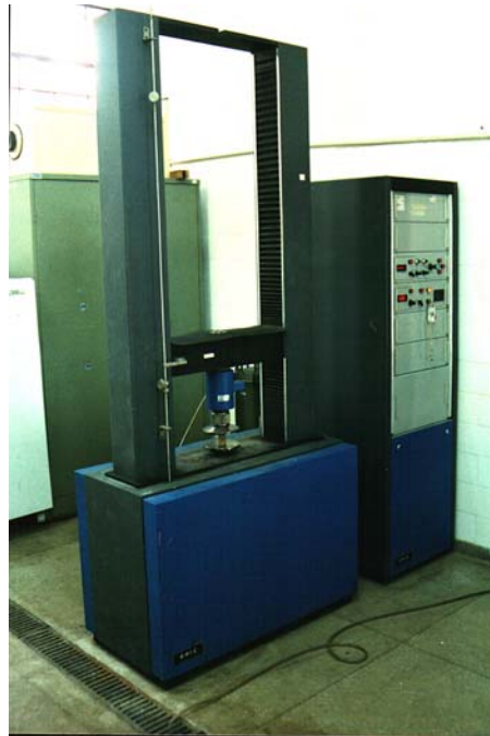
Figura 7 – Máquina universal de ensaios – capacidade 10.000 kgf
