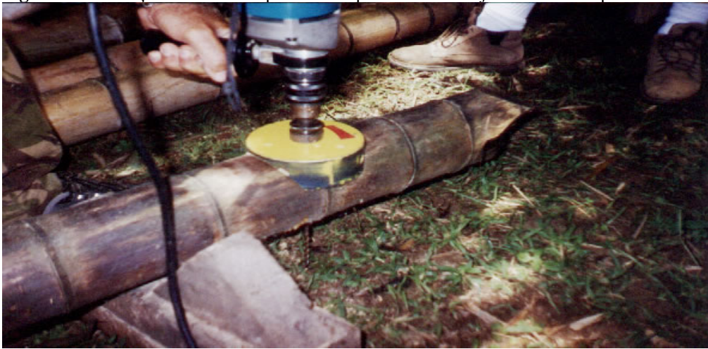
Figura 34: Obtenção de encaixe tipo Boca de pescado com a ajuda da serra copo.
