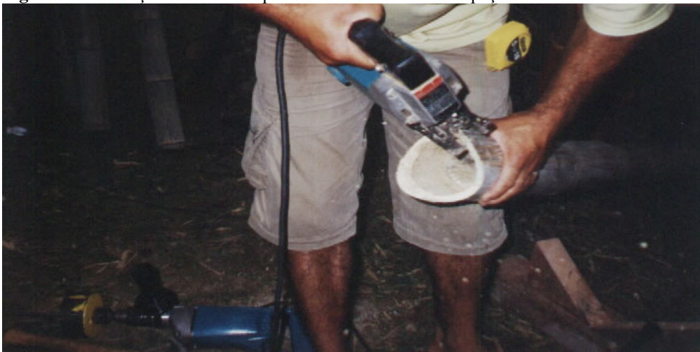
Figura 35: Execução do arremate para melhorar o encaixe da peça com serra tico-tico.
