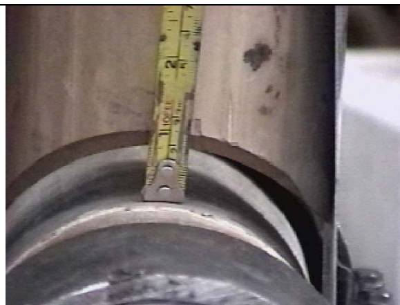
FOTO 28 FLUENCIA DE LA LAMINA
