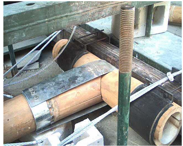
FOTO 24 FALLA SC 90° COMPRESION (2)
