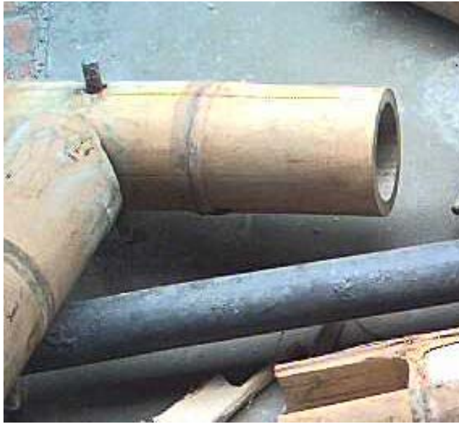
FOTO 43 FALLA UNION DG 90° TENSION
