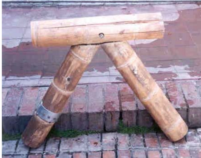
FOTO 40 FALLA UNION DG 60°
